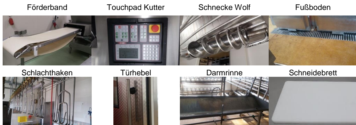
Abbildung 21: Beschichtete Oberflächen und Gerätschaften zur mikrobiologischen Untersuchung
