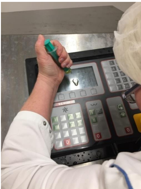
Abbildung 11: Tropftest Touchpad am Kutter
