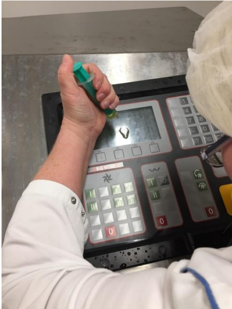
Abbildung 7: Tropfentest mit Öl
